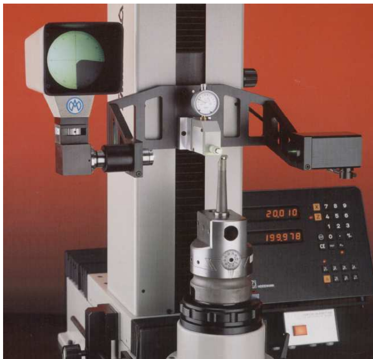
Rys. 16. Urządzenia optyczne do pomiarów wartości korekcyjnych narzędzia poza obrabiarką [www.afm.com.pl, www.avia.pl].
