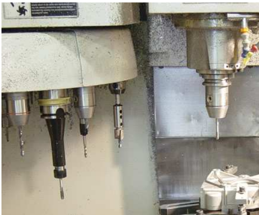
Rys. 15. Urządzenia do automatycznej wymiany narzędzi: a) głowica rewolwerowa z napędzanymi narzędziami, b) głowica rewolwerowa bębnowa, c) magazyn narzędzi [www.afm.com.pl, www.avia.pl].
