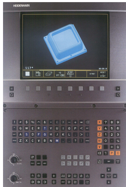
Rys. 17. Pulpit sterowniczy frezarki MIKRON z układem sterowania numerycznego HEIDENHAIN z widoczną symulacją obróbki przedmiotu [www.afm.com.pl, www.avia.pl].
